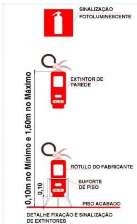
Fig. 02 – Detalhes fixação extintores
